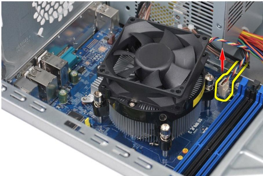
4. Menggunakan obeng Phillips, kendurkan keempat baut mati yang menahan unit pendingin dan kipas pada board sistem.
